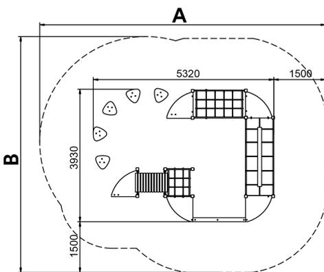
**Estructura, Metal:** Postes galvanizados y lacados en polvo, con gran resistencia a la abrasión, la corrosión y la intemperie. La superficie deslizante del tobogán es de acero inoxidable pulida AISI304 de 2 mm de grosor y está curvada, ondulada y modelada en una sola pieza. Barras protectoras en acero inoxidable AISI304 de Ø32mm.
