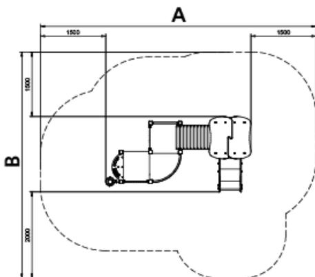
Estructura, Metal: Postes de 80x80x2mm galvanizados en caliente y lacados en polvo, con gran resistencia a la abrasión, la corrosión y la intemperie. La superficie deslizante del tobogán es de acero inoxidable pulida AISI304 de 2 mm de grosor y está curvada, ondulada y modelada en una sola pieza.
