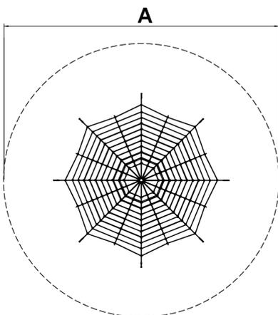
**Estructura, Metal:** Los mástiles son de acero galvanizado en caliente y son el centro de la estructura fundamental de las redes tridimensionales. Su función es equalizar las oscilaciones de la red y soportar altas cargas provenientes de los diferentes ejes.
