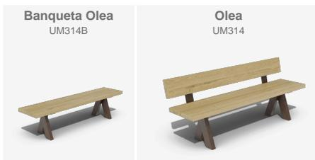
La OLEA es una grada fabricada con pies tubulares de acero corten de 50 x 100 mm. Tablones de sección 210 x 50 mm fabricados en madera de pino tratada en autoclave vacío-presión clase 4 contra la carcoma, termitas e insectos.
