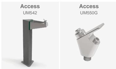
Fuente fabricada de acero con tratamiento Ferrus, proceso protector del hierro que garantiza una óptima resistencia a la corrosión. El tratamiento Ferrus se compone de tres capas que se aplican después de limpiar toda la suciedad y las impurezas mediante granallado y consiste en un baño electrolítico, seguido de una capa de imprimación epoxi y un último recubrimiento de pintura poliéster color gris martelé.
