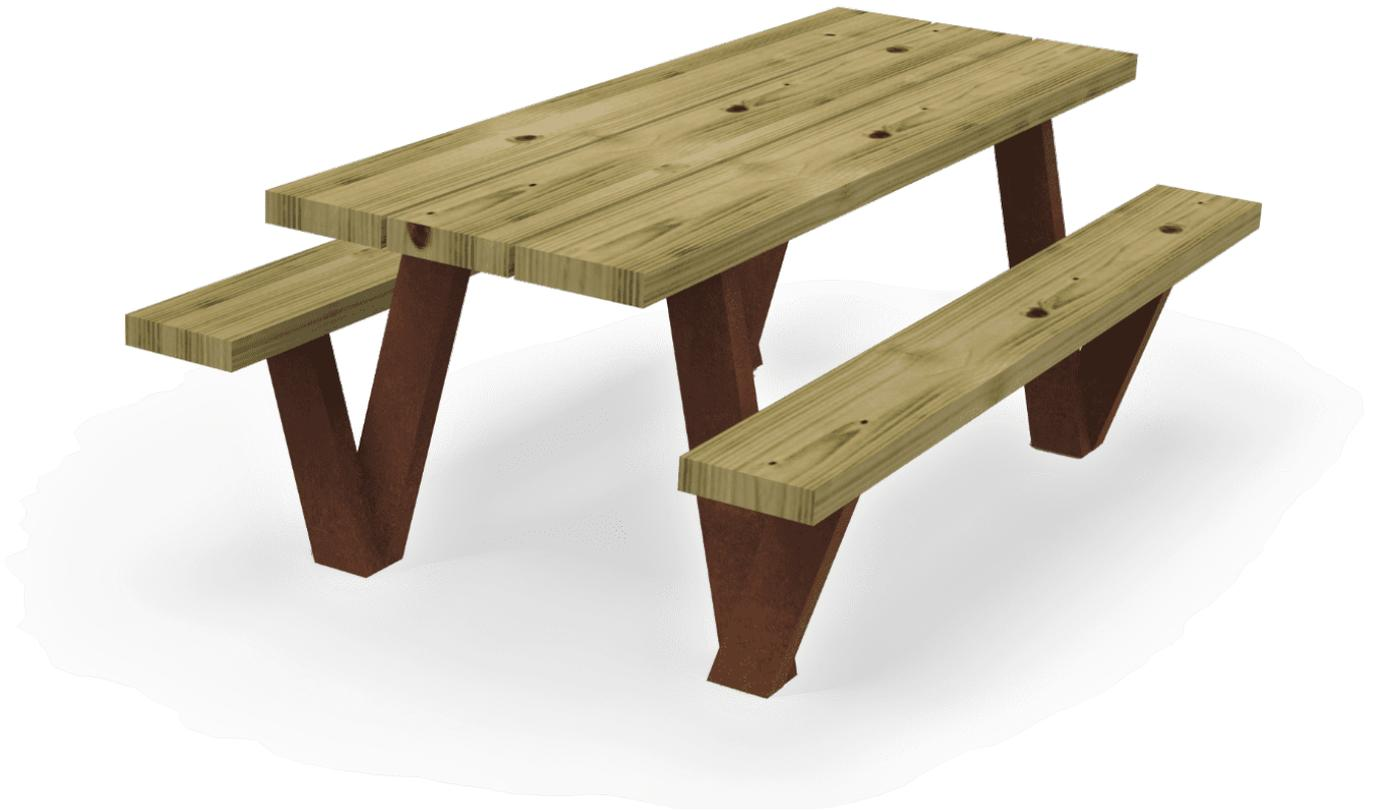
Mesa fabricada con pies tubulares de acero corten de 50 x 100 mm. Tablones de sección 210 x 50 mm en madera de pino tratada en autoclave vacío-presión clase 4 contra la carcoma, termitas e insectos. Tornillería de acero inoxidable.
