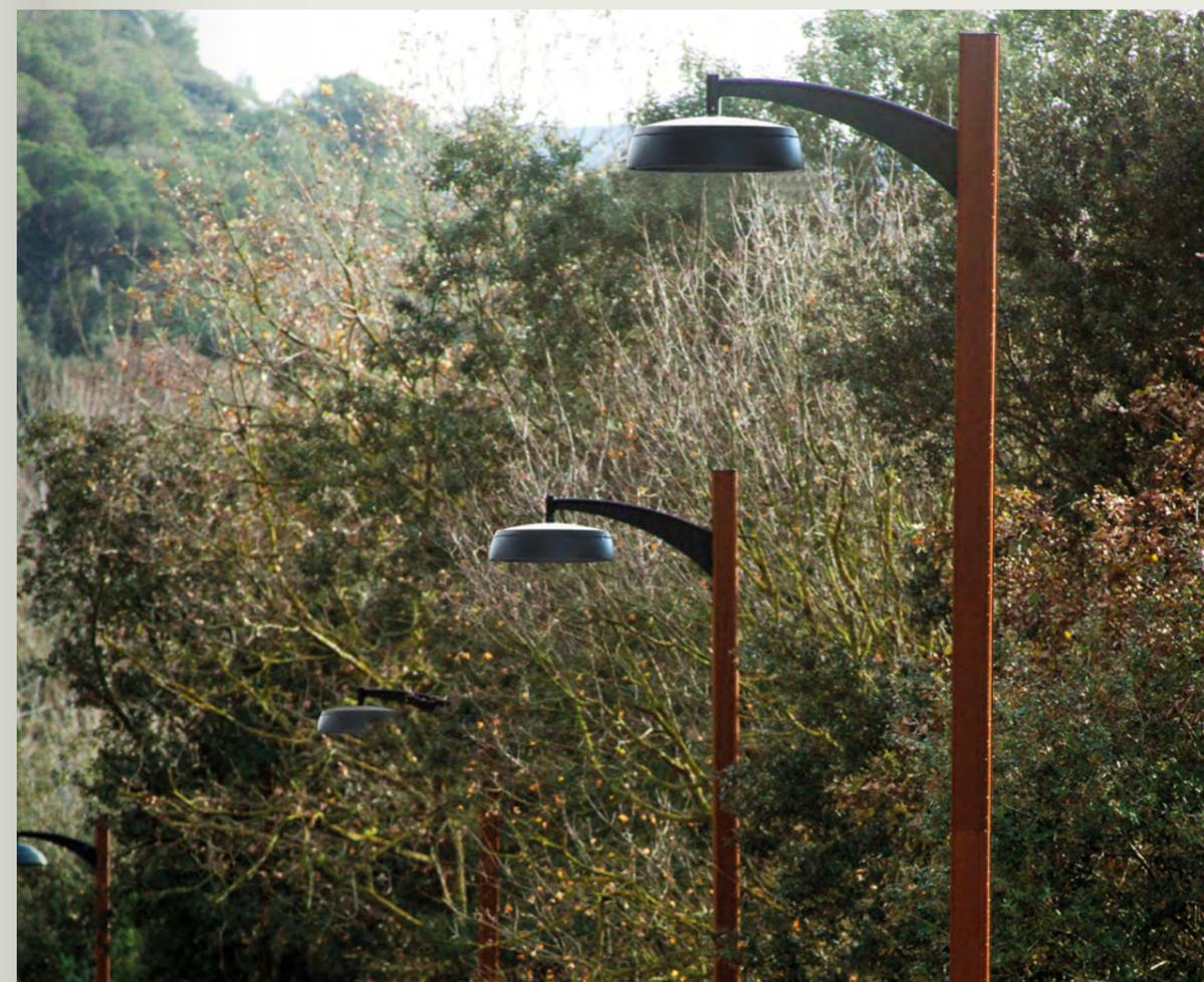
Columna con base y brazo de acero en acabado galvanizado y pintado con una capa de imprimación epoxi y una de pintura poliéster, ambas pulverizadas electrostáticamente y sublimadas al horno, color negro forja y fuste de laminado de madera de pino escandinavo con tratamiento autoclave Clase IV.
