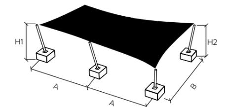
Todas las estructuras se fabrican en tubo de acero galvanizado en caliente o bien pintadas al horno con pintura en polvo de poliéster. Las telas son de polietileno de alta densidad, según especificaciones de ficha técnica
