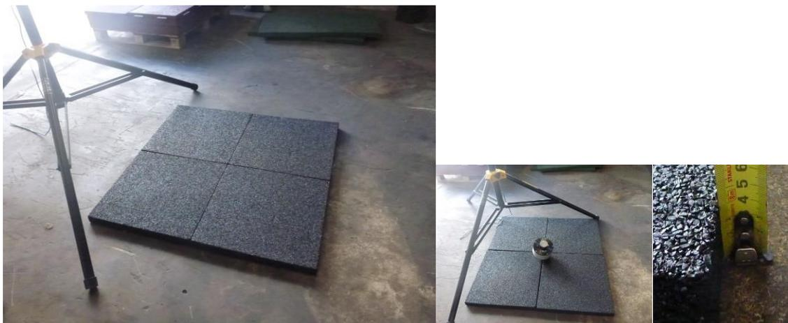
Ensayada el 05 de noviembre de 2021 en Avda. Bertrán i Güell nº25, 08850 Gavà, Barcelona, según **Método de ensayo 1 (ensayos en laboratorio) - Determinación de la altura de caída crítica (ACC)** de la Norma **UNE-EN 1177:2018+AC Mayo 2019**, con informe de resultados de ensayo **1799 21 11 0501**, es conforme con el siguiente resultado de **altura de caída crítica**:
