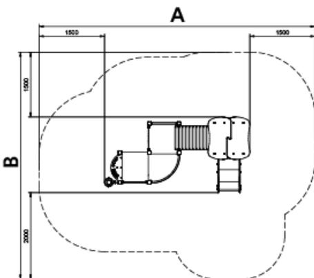
Estructura, Metal: Postes de 80x80x2mm galvanizados en caliente y lacados en polvo, con gran resistencia a la abrasión, la corrosión y la intemperie. La superficie deslizante del tobogán es de acero inoxidable pulida AISI304 de 2 mm de grosor y está curvada, ondulada y modelada en una sola pieza.
