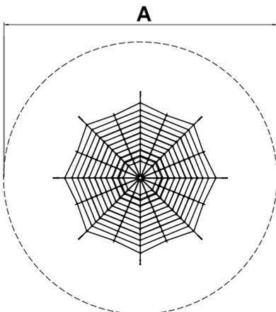
**Estructura, Metal:** Los mástiles son de acero galvanizado en caliente y son el centro de la estructura fundamental de las redes tridimensionales. Su función es equalizar las oscilaciones de la red y soportar altas cargas provenientes de los diferentes ejes.
