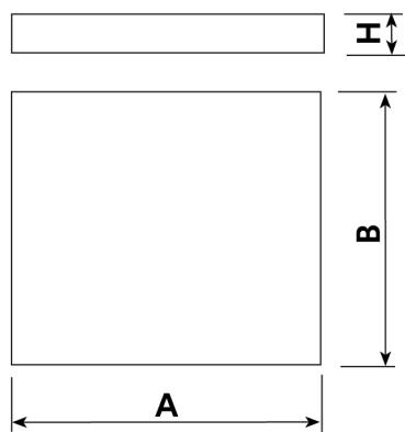
Losetas elásticas prefabricadas, monocapa, producida con gránulos de caucho negro reciclado, pigmentos y resinas de poliuretano. Estas son analizadas y fabricadas conforme a la normativa Europea EN-1177, por lo que responden a las exigencias de una absorción de impacto de más de 70%.
