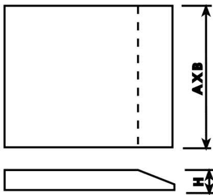
Losetas elásticas prefabricadas, monocapa, producida con gránulos de caucho negro reciclado, pigmentos y resinas de poliuretano. Estas son analizadas y fabricadas conforme a la normativa Europea EN-1177, por lo que responden a las exigencias de una absorción de impacto de más de 70%.
