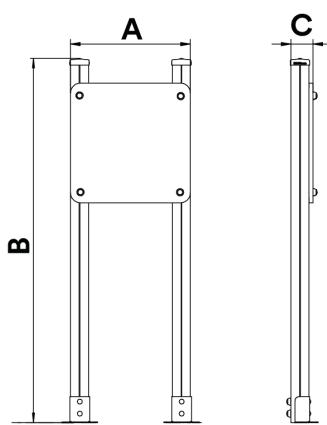
**Estructura, Madera laminada:** Madera de pino escandinavo laminada y con tratamiento autoclave (clase IV). -En el caso de estar sometida a condiciones meteorológicas variables, la madera laminada puede presentar pequeñas grietas que no reducen su durabilidad. La resina y los nudos son su parte natural.
