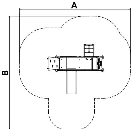
**Estructura, Metal:** Postes galvanizados y lacados en polvo, con gran resistencia a la abrasión, la corrosión y la intemperie. La superficie deslizante del tobogán es de acero inoxidable pulida AISI304 de 2 mm de grosor y está curvada, ondulada y modelada en una sola pieza. Barras protectoras en acero inoxidable AISI304 de Ø32mm.
